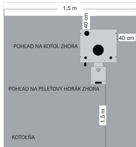
Obrázok č. 2 Vhodné umiestnenie kotla v kotolni
